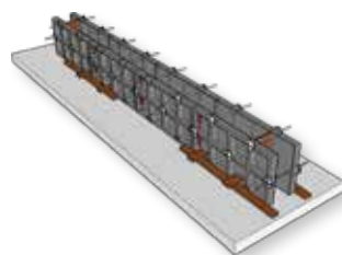
Betonnen balken op betonplaat
